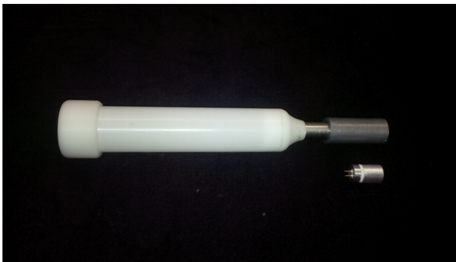
Рис 4. Гамма-локатор с вольфрамовым коллиматором и сцинтилляционная сборка \text{LaBr}_3(\text{Ce}) с SiPM.
