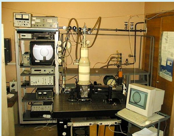
Характеризация КТМ: 100-проекционный видео-томограф с разрешением 1 \mu\text{m} (при \lambda=490\mu\text{m} )
