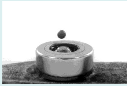
Мишень с ВТСП покрытием в магнитном подвесе
