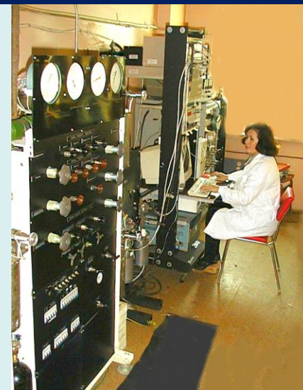
Установка заполнения: Заполнение оболочек газом до 1000 атм при 300 К
