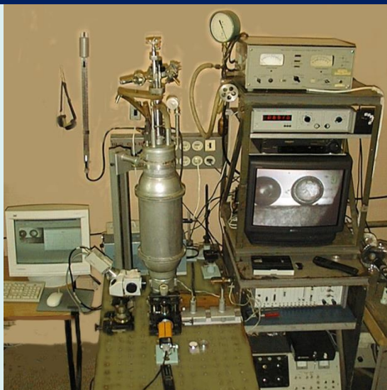
Модуль формирования (МФ): Метод FST для формирования крио слоя внутри движущей оболочки
