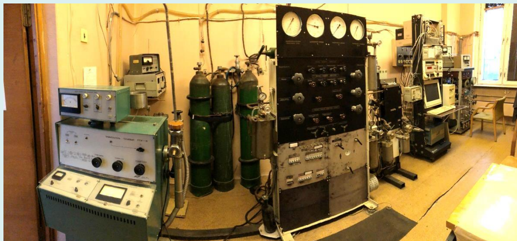
Комплекс для заполнения оболочек топливом до 1000 атм
