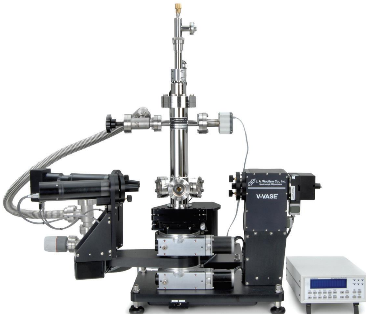
Рис. 2. Спектральный эллипсометр Woollam VASE с установленным на нем оптическим криостатом CRV-725V фирмы Janis.
