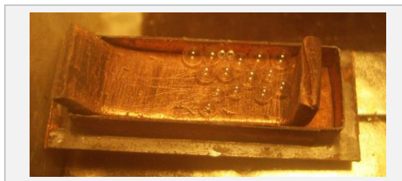
Рис. 7. ВТСП сабот (Gd123) с медной вставкой и полимерными оболочками перед началом эксперимента.
