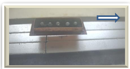
Рис. 1. Движение ВТСП сабота типа «корыто» с массивом сферических оболочек (диам. 2 мм) над магнитным рельсом под действием гравитации.
