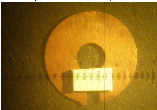
Рис.2. Мишень CD2 с плотностью 1/3 от сплошного пластика, толщиной 250 мкм на шайбе 8 мм диаметра
