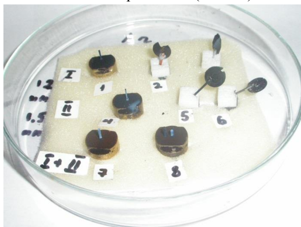
Рис. 10. Изображения образцов мишеней со свидетелями процесса нанесения пены из малоплотного золота для последующего разрушающего контроля толщины и плотности пены в мишени.
