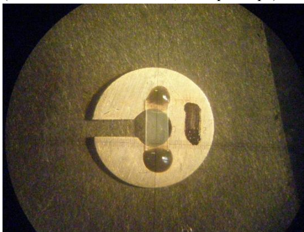
Рис. 1. Мишень дейтерированного полиэтилена твердотельной плотности на шайбе-держателе 8 мм диаметра
